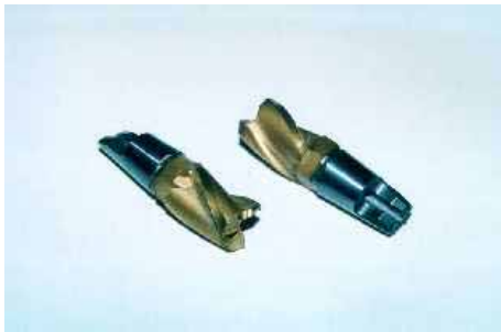
Головка фрезы для обработки твердых сплавов (Источник: Seco Tools AB)
